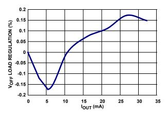
FIGURE 15.  $V_{\mbox{OFF}}$  LOAD REGULATION
