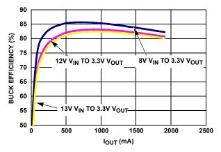
FIGURE 9. BUCK EFFICIENCY @ 1.3MHz
