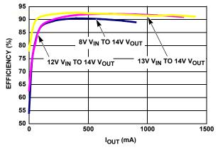
FIGURE 2. BOOST EFFICIENCY @ 1.3MHz
