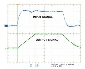
FIGURE 17.  $V_{COM}$  RISING SLEW RATE
