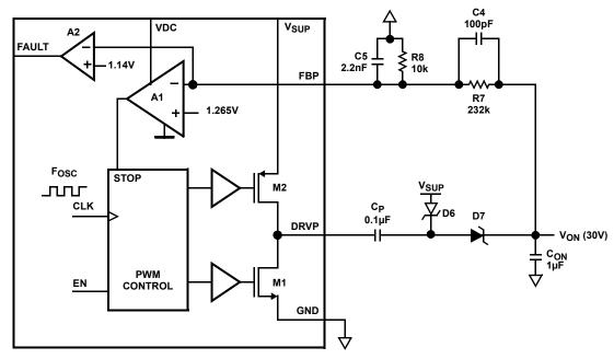
FIGURE 18A. V<sub>ON</sub> FUNCTION DIAGRAM (VOLTAGE DOUBLER)
