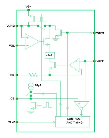
FIGURE 20. VON-SLICE BLOCK DIAGRAM
