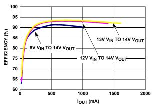
FIGURE 1. BOOST EFFICIENCY @ 650kHz
