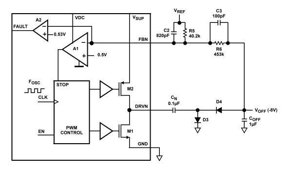
FIGURE 19. NEGATIVE CHARGE PUMP BLOCK DIAGRAM
