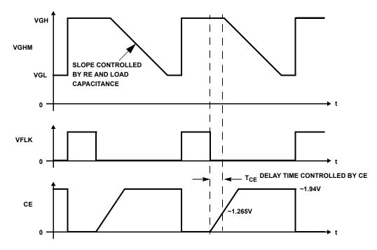
FIGURE 21. VON-SLICE TIMING WAVEFORM
